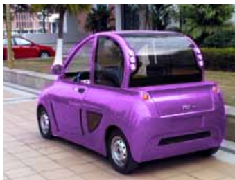
O EMUV tem uma autonomia de 160 km a uma velocidade constante de 90 km/h
