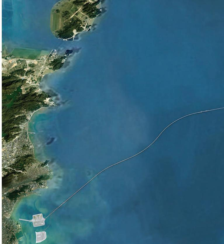
a travessia é ainda constituída por quatro ilhas artificiais e pelo mais longo túnel marítimo do mundo, uma infra-estrutura que se estende por 6,7 quilómetros a uma profundidade média de 40 metros abaixo do leito oceânico.
